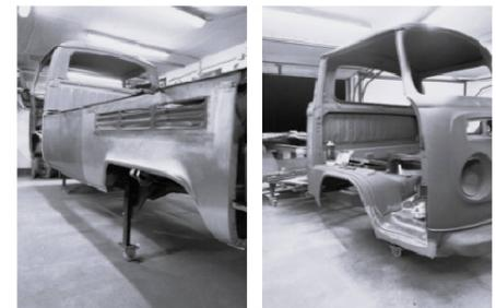
Eine Pritsche, für mich, seinen Vater, „FETZEN HIN“, für ihn, Kevin, „gute Restaurationsbasis“. Nach der Demontage aller Anbauteile, einfach gesagt, alles was zum Abschrauben und Ausbauen war, wurde das „Häusl“, Türen und Achsen zum Sandstrahlen gebracht und anschließend grundiert, damit vorerst so der Rost gestoppt wurde und nicht weiterarbeiten konnte.
